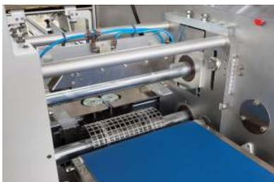
**Testa di saldatura trasversale ad elevate prestazioni**
