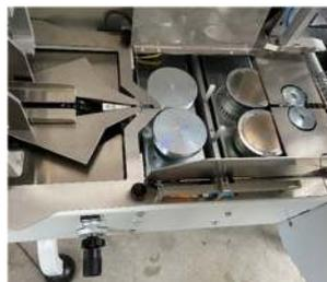
**1° coppia di rulli di saldatura inclinabili**
