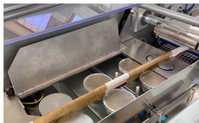
Tre coppie di rulli di saldatura, il primo è inclinabile
