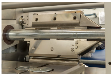
Testa di saldatura trasversale ad elevate prestazioni (doppia ganascia opzionale)
