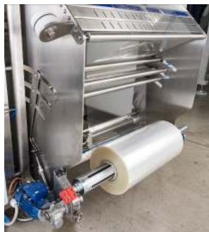
Portabobina motorizzato con bloccaggio pneumatico
