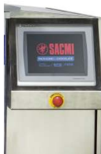
Cabina di controllo con tetto spiovente e 10" HMI touch screen a colori
