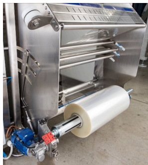
Portabobina motorizzato con bloccaggio pneumatico
